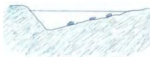
Figur 19: Principskitse for svingprofil af det nye forløb.
